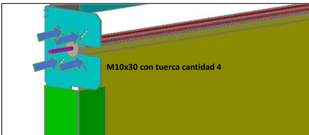
Fijar las placas base inferiores en la parte inferior de las perneras (directamente al suelo)
