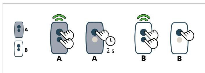
**Uzaktan kumanda "A"** = önceden hafızaya alınmış "kaynak" uzaktan kumanda
